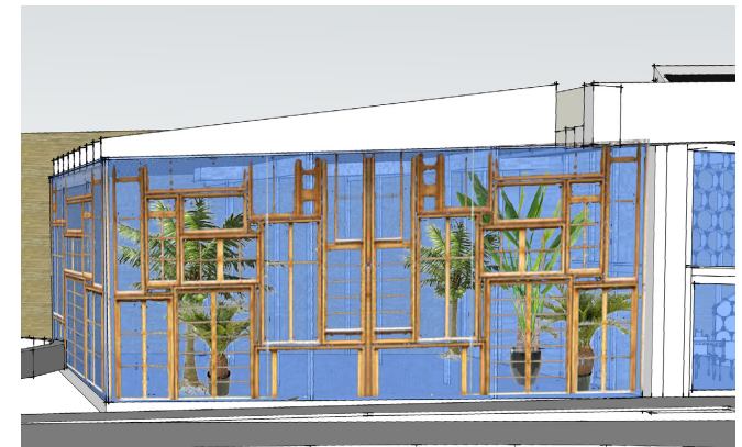
Impressie gevel van de kas opgebouwd uit gerecyclede kozijnen
